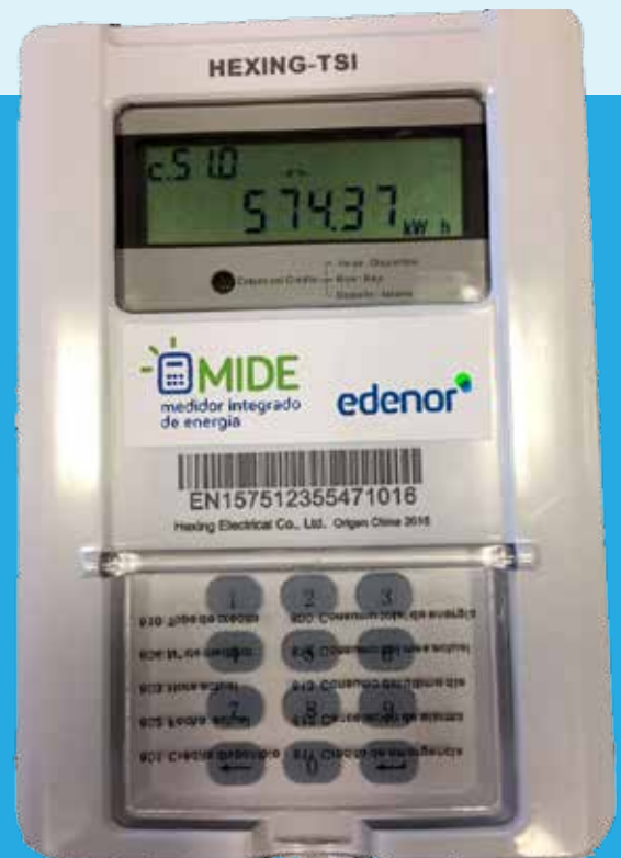
Medidor integrado de energía de EDENOR.
