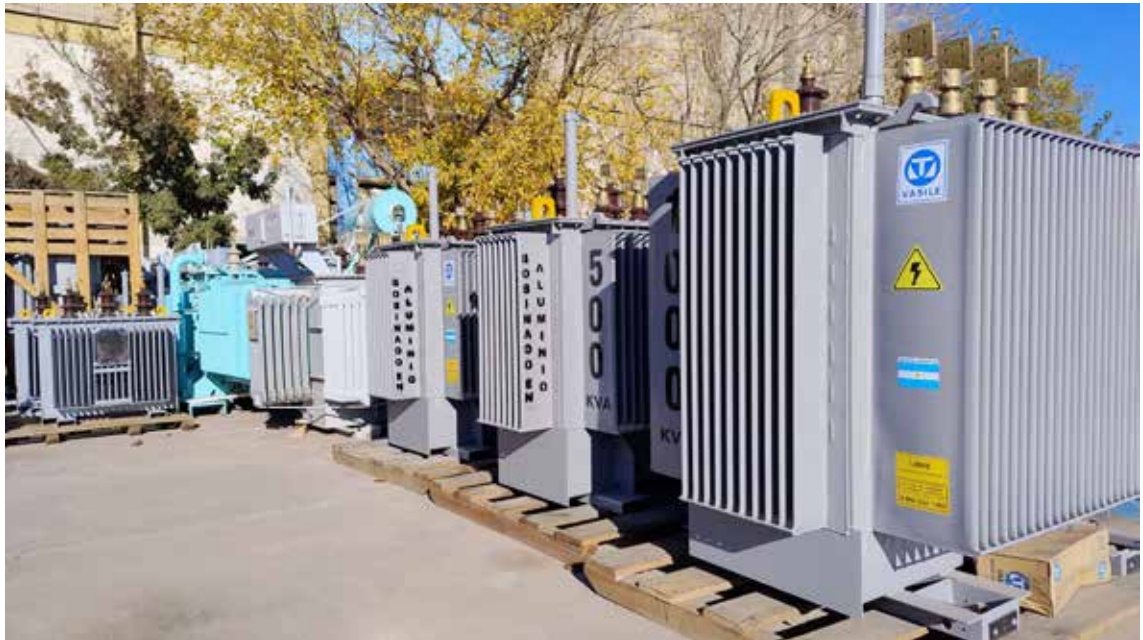
La distribuidora comenzó a utilizar conductores y transformadores de aluminio en sistemas de baja tensión, acometidas aéreas y alumbrado público
