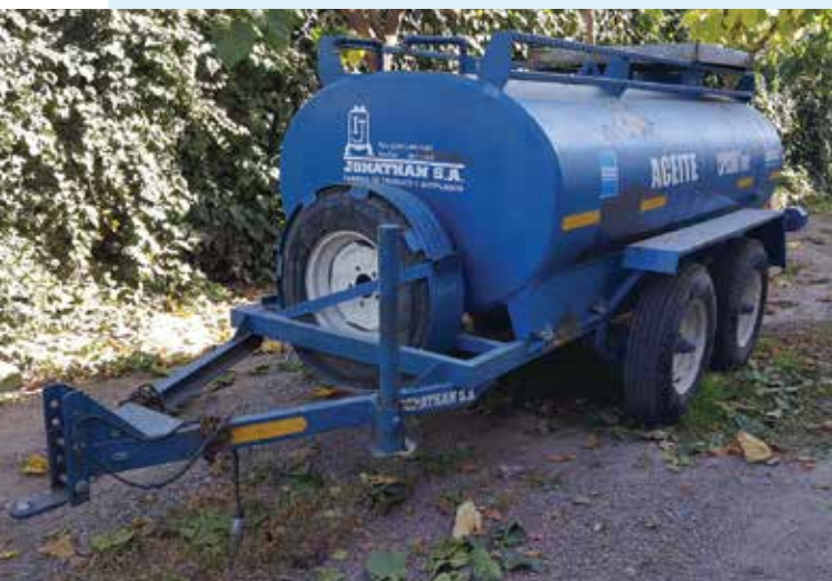
Cisterna móvil para recolectar aceite usado. Cisterna para aceite a regenerar.
