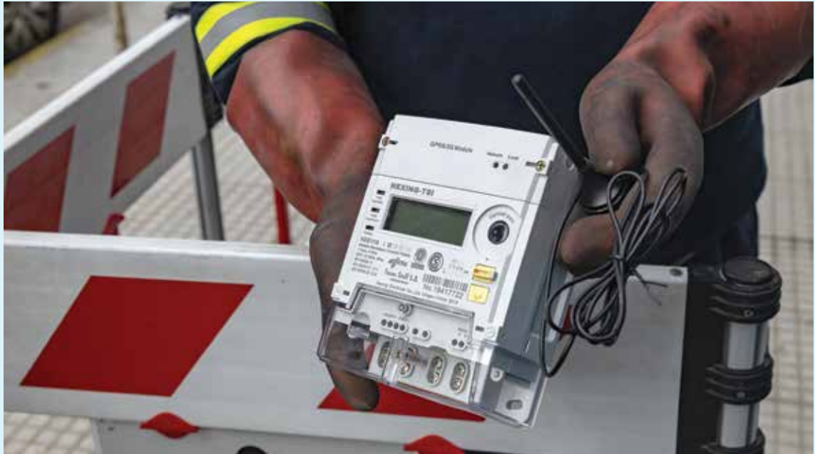
Medidor monofásico inteligente bidireccional instalado en el barrio de Colegiales.
