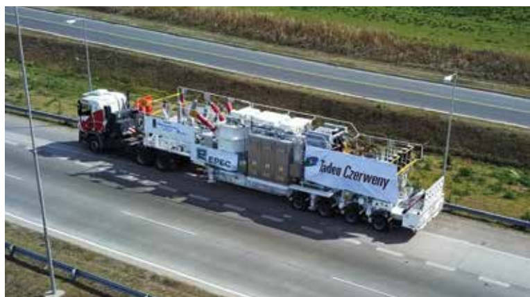
Estación Transformadora Móvil.
