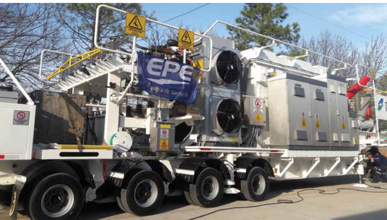
Estación transformadora móvil.
